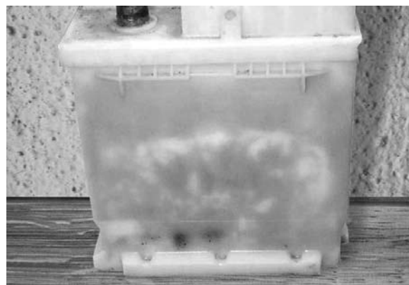
Figura 11 – Foto de una batería con descarga profunda con sulfatación
